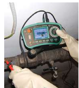
Continuity check of equipotential bonding
